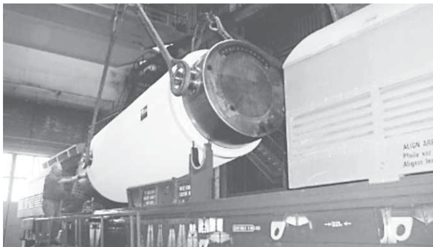
Транспортный контейнер TN-13/2 производства Франции для перевозки ОЯТ
