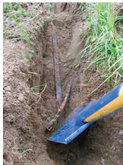
Рис. 4. Разрушение сварного соединения в узле присоединения заземляющего спуска к ЗУ на шинной опоре 110 кВ
