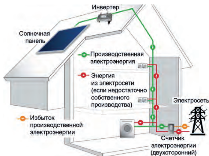
Рис. 3. Схема подключения к электросети солнечных панелей, производящих электроэнергию для внутреннего потребления
