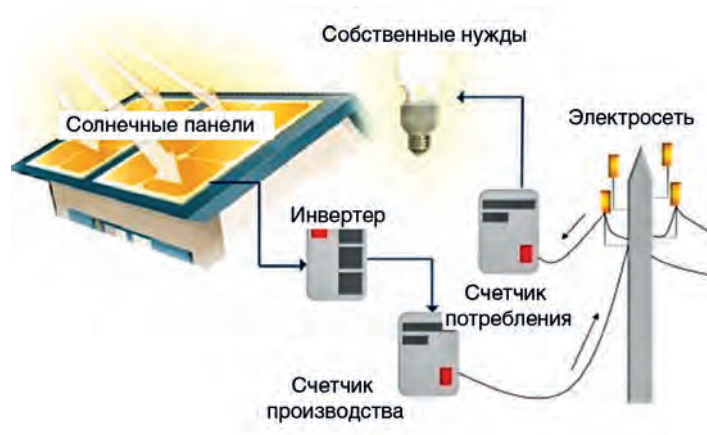
Рис. 2. Схема соединения электросети с солнечной панелью при полной продаже произведенной электроэнергии
