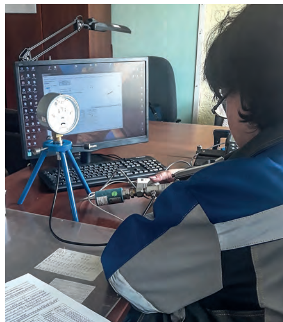
Поверка показывающего манометра с использованием программного продукта
