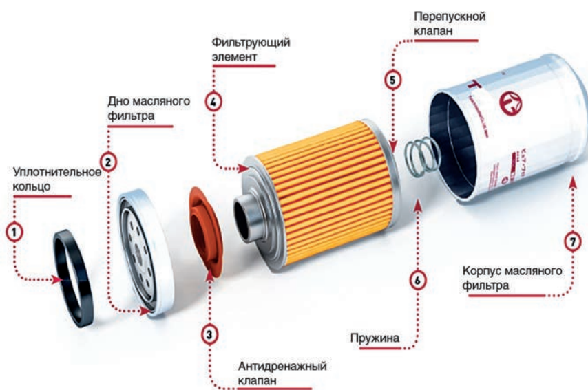
Рис. 1. Элементы современного масляного фильтра и материалы, из которых они изготовлены: 1, 3 – эластомеры; 2, 5–7 – металл; 4 – бумага, картон
