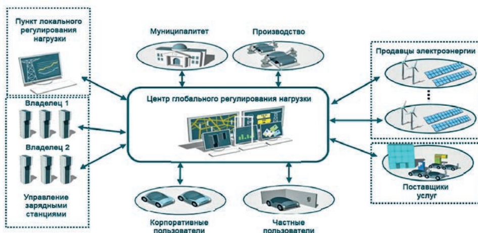
Рис. 1. Структурная схема системы динамического регулирования нагрузки (ДРН)
