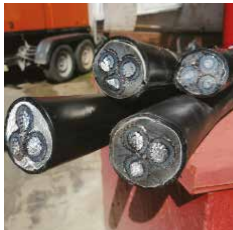
Трехжильный кабель с изоляцией из сшитого полиэтилена
