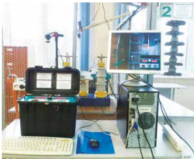
Рис. 4. Экспериментальная установка для моделирования электрической дуги в трансформаторном масле
