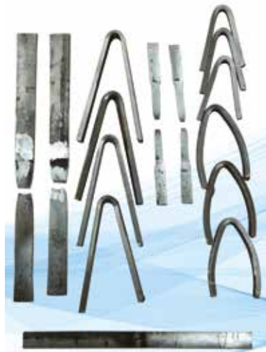
Результаты проведения механических испытаний образцов, вырезанных из стальных подземных газопроводов
