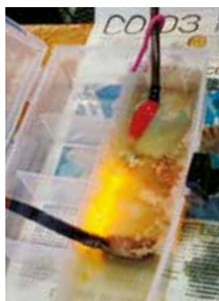
Рис. 4. Экспериментальная установка для моделирования электрической дуги в трансформаторном масле
