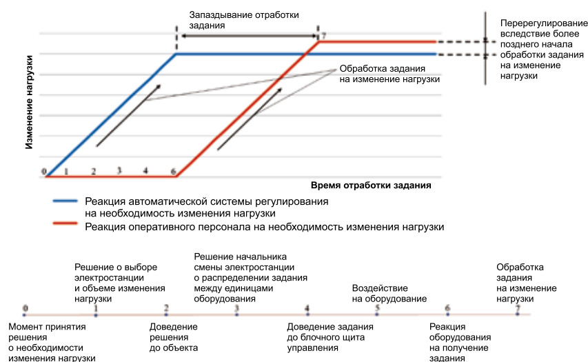
Рис. 2. Прохождение и реализация команды на изменение нагрузки генерирующего оборудования
