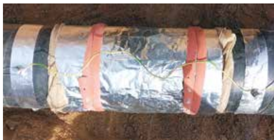
Рис. 2. Измерение переходного сопротивления по методике АМИ ГР 0017-2021
