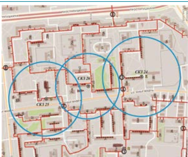
Рис. 3. Схема контролируемого участка газопровода в квартале многоэтажной застройки г. Минска
