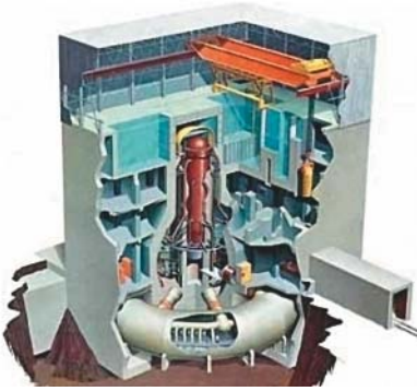
Рис. 1. Общий вид реакторного отделения энергоблока с BWR-3, 4
