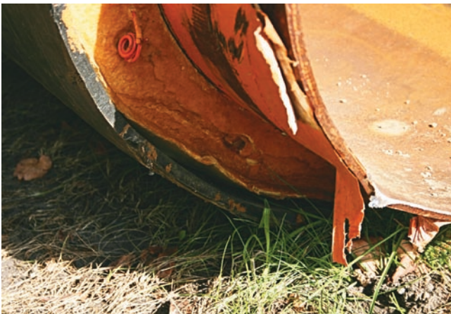
Рис. 1. Дефекты при разгрузке
