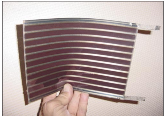
Рис. 6. Внешний вид гибкой PV-пленки производства фирмы Klockner Pentaplast
