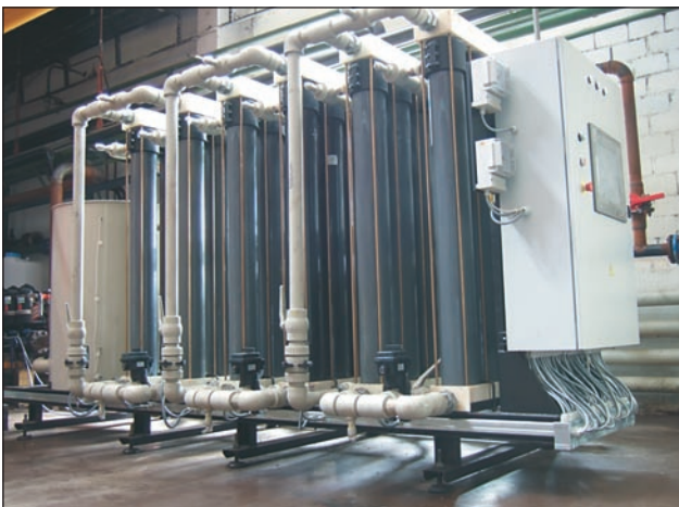
Рис. 7. Головной образец промышленной ультрафильтрационной установки, разработанной Институтом физико-органической химии НАН Беларуси (изготовитель – ОАО «Белэнергоремналадка»)
