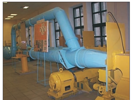
Рис. 2. Две воздушные турбины, оснащенные современной системой вибрационного контроля
