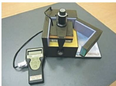
Рис. 3. Лабораторный стенд «Определение теплотехнических свойств материалов»
