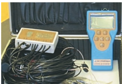
Рис. 3. Лабораторный стенд «Определение теплотехнических свойств материалов»
