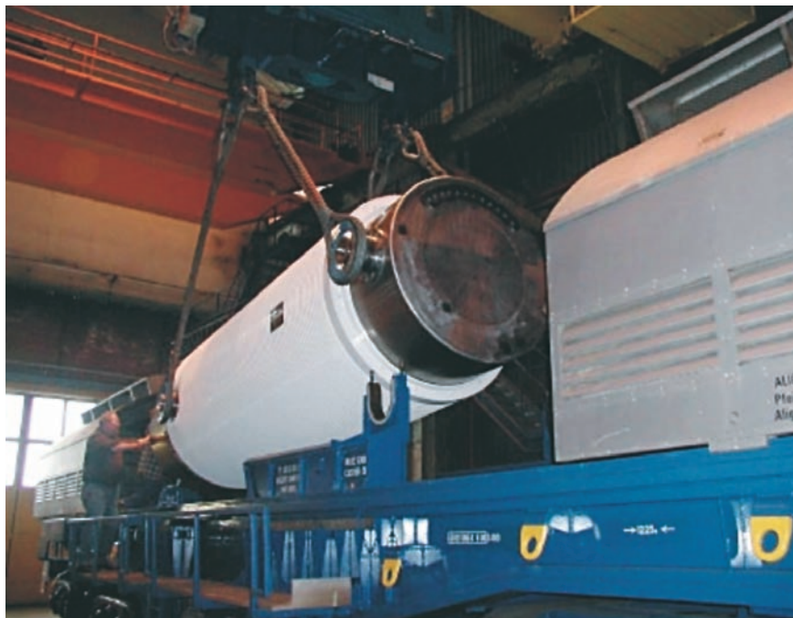
Транспортный контейнер TN-13/2 производства Франции для перевозки ОЯТ
