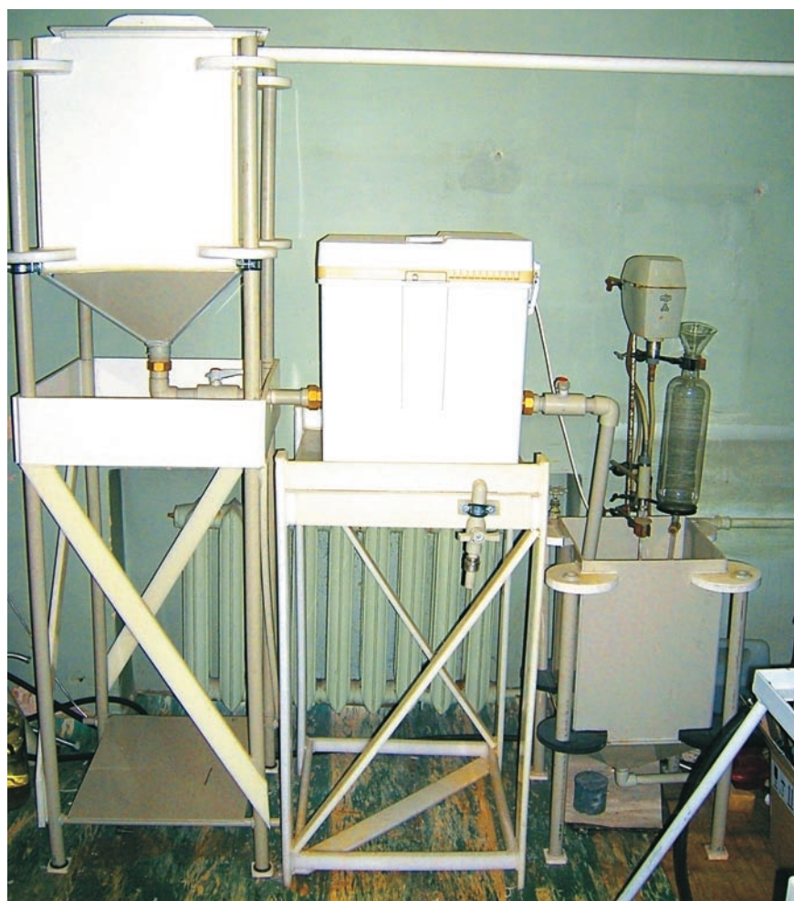
Рис. 1. Установка для приготовления волокнистых палладийсодержащих катализаторов
