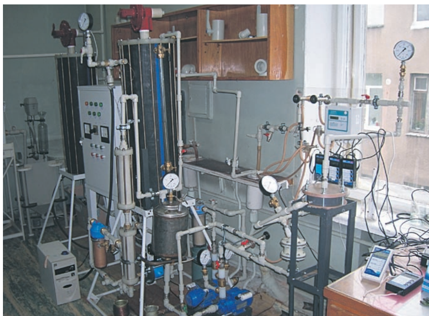
Рис. 3. Экспериментальная установка для определения активности катализаторов в обескислороживании воды
