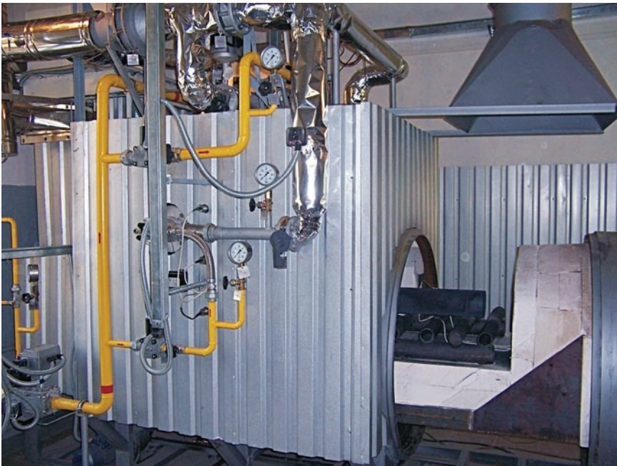
Рис. 2. Лабораторный стенд «Нагревательная печь с выкатным подом» (Институт тепло- и массообмена им. А.В. Лыкова НАН Беларуси)
