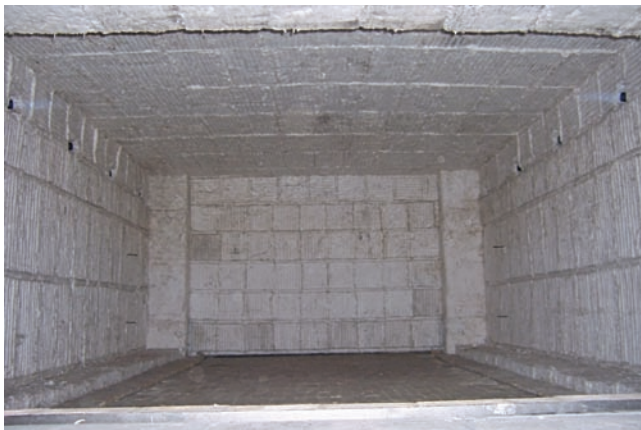
Рис. 5. Новая волокнистая футеровка в рабочей камере печи
