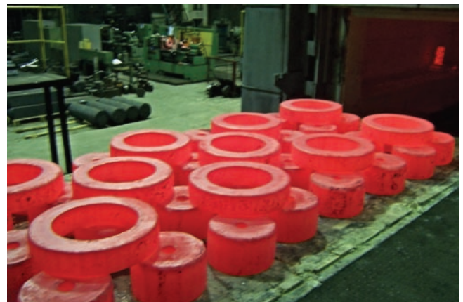
Рис. 6. Стальные поковки после операции отжига в новой печи
