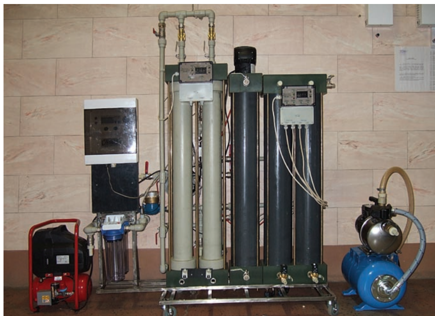
Рис. 2. Внешний вид опытной передвижной многофункциональной установки водоочистки производительностью 1 м 3 /с с автоматической системой регенерации мембранных элементов
