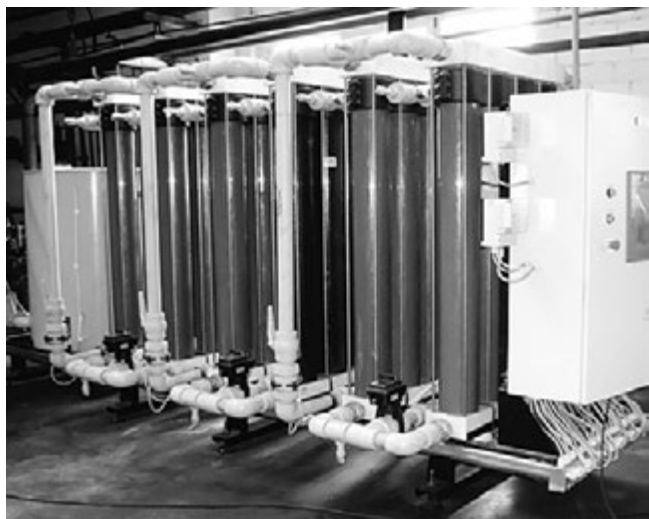
Головной образец промышленной автоматизированной установки ультрафильтрационной очистки
