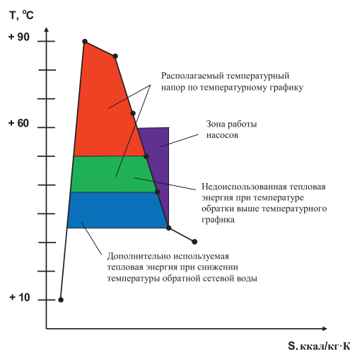
Схема распределения температурного напора в зависимости от температуры обратной сетевой воды
