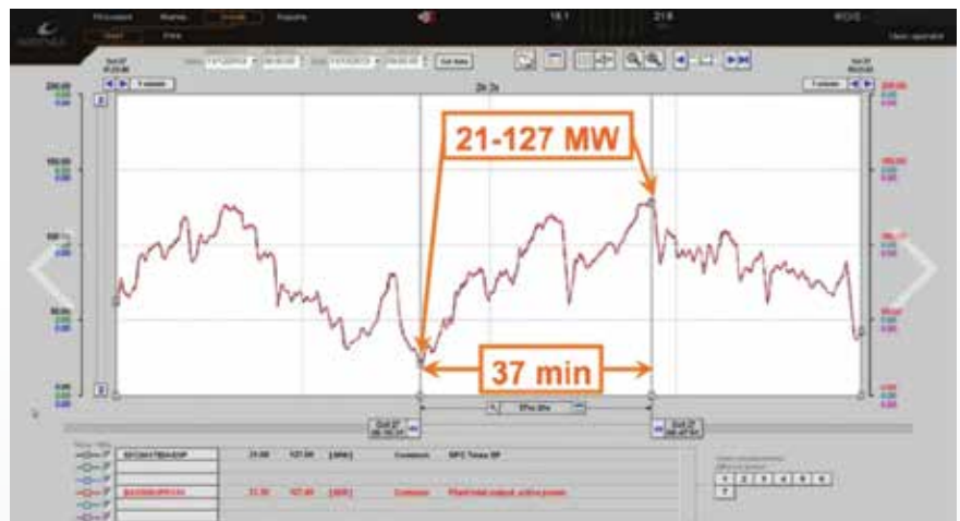
Рис. 2. Вторичный резерв и поддержание баланса сети станций 132 МВт, состоящей из семи двигателей Wärtsilä 50SG:
