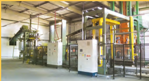
Линия по производству торфяных субстратов торфопредприятия «Глинка»
