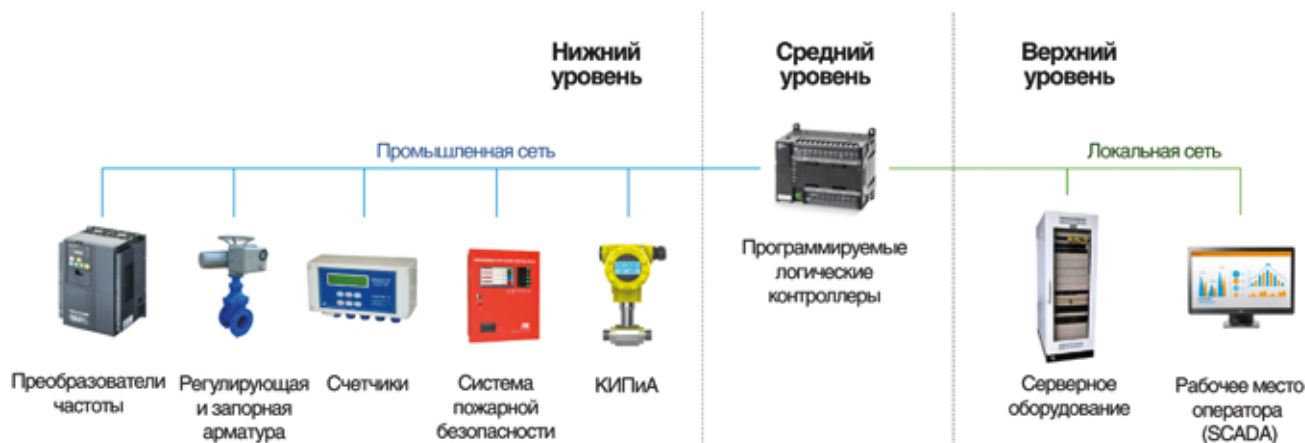
Структурная схема объединения в информационные сети различного оборудования, применяемого для реализации АСУ насосных станций
