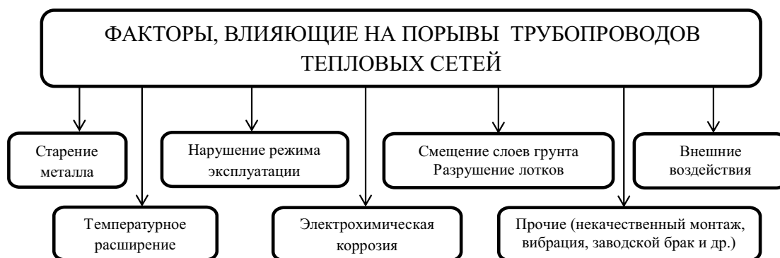
Рис. 3. Факторы, влияющие на порывы трубопроводов тепловых сетей
