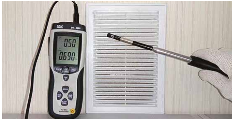
Измерение скорости воздушного потока анемометром
