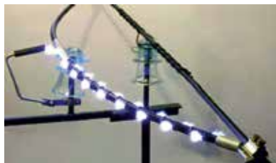
Разрядник длинно-искровой шлейфовый (РДИШ) в процессе гашения
