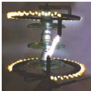
Разрядник мультикамерный экранного типа РМКЭ-35 в процессе гашения
