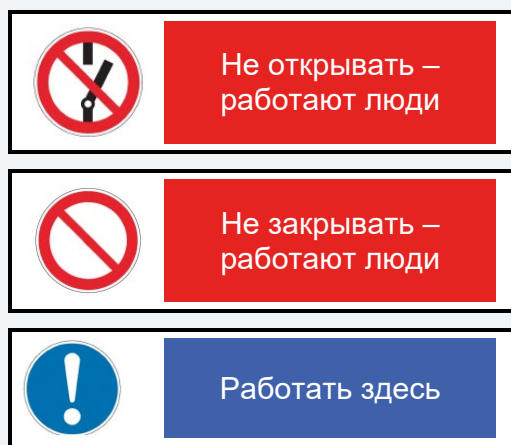
Рис. 5. Комбинированные знаки, вывешиваемые на отключающей арматуре (а), ключах управления ее электроприводами (б) и на месте работы (в)
