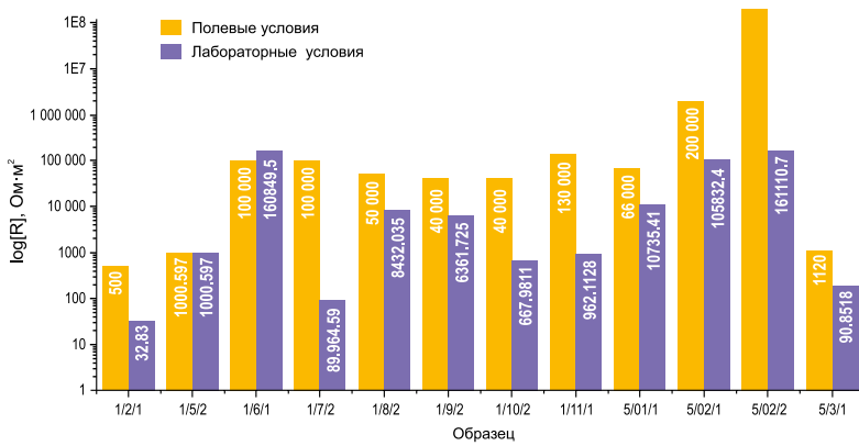
Рис. 3. Результаты измерения переходного электрического сопротивления образцов, полученные в полевых и лабораторных условиях
