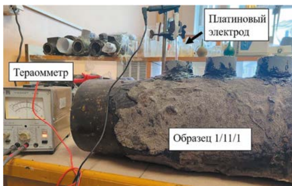
Рис. 1. Схема измерения переходного электрического сопротивления
