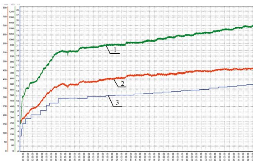
Рис. 4. Зависимость виброперемещения выводного конца ШС 1С5' в радиальном направлении от активной мощности: 1 – активная мощность; 2 – виброперемещение ШС; 3 – ток обмотки статора генератора
